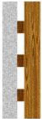
ESEMPIO DI SOLUZIONE: I “diaframmi” sono pannelli di legno fissati al muro con assicelle e attenuano i suoni a bassa frequenza
